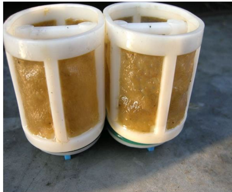
Foto: Voorbeeld verontreiniging filter met micro-organismen.
